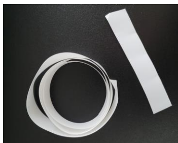
Fig. 1. Cliché photographique de film zéolithe/polymère élaboré par une extrudeuse de laboratoire
